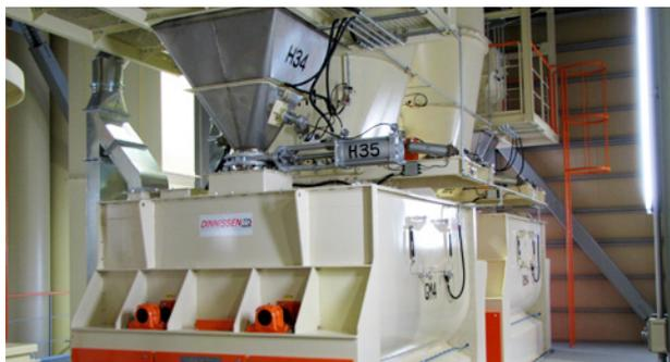
主配合混合設備（ツインパドルミキサー）
